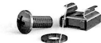
Imagem de referência - Parafuso com porca (KIT de parafuso com cabeça tipo panela philips e porca gaiola, de tamanho M5, ambos em aço inox ou aço carbono inox.)
