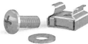
Imagem de referência - Parafuso com porca (KIT de parafuso com cabeça tipo panela philips e porca gaiola, de tamanho M5, ambos em aço inox ou aço carbono inox.)
